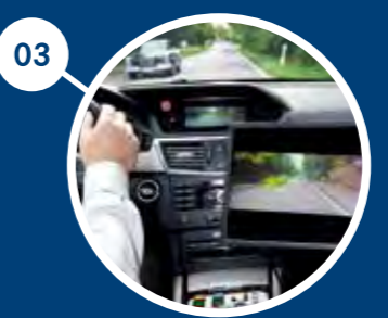
03 6D ビジョン 車内に設置したステレオカメラの映像を瞬時に解析する画像認識技術
