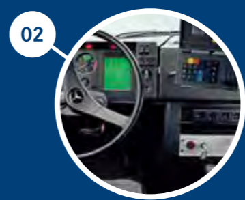
02 PROMETHEUS II 電子部品を利用することで、車間距離制御システムやナビゲーションシステムのテストを実施しました。
