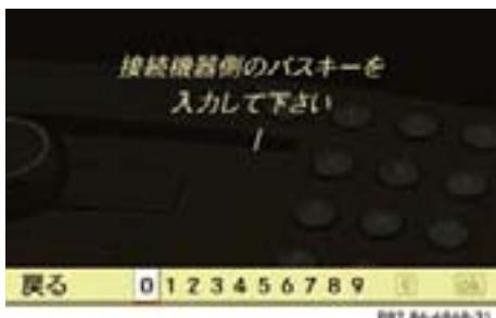
▶ コントロールダイヤルをまわすか、コントロールスティックを左右に倒す、または文字入力キーを押して、パスキーの数字を入力します。
