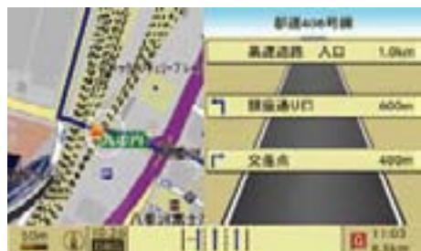
表示形式の " 分岐点案内図 " が設定されているときは (▷57 ページ)、ルート案内を行なって一般道を走行しているときに分岐点案内が表示されます。
