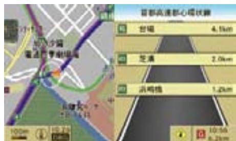
表示形式の " 高速案内図 " が設定されているときは (▷57 ページ)、高速道路を走行しているときに高速案内図が表示されます。
